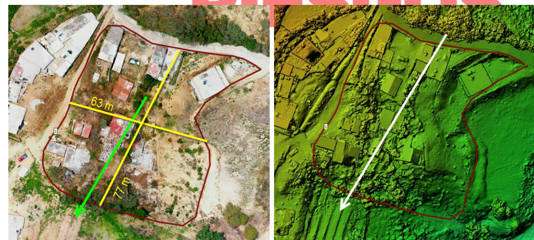
Figura 14. Ortoimagen y MDE del deslizamiento ubicado en el Barrio Primera de San Miguel.
